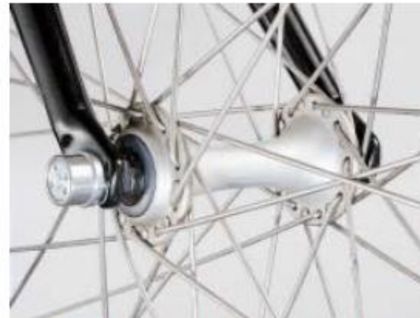
Le tirant antivol, fabriqué par un décolleteur, empêche les voleurs de démonter la roue sur les parkings à vélos type pince-roue.
